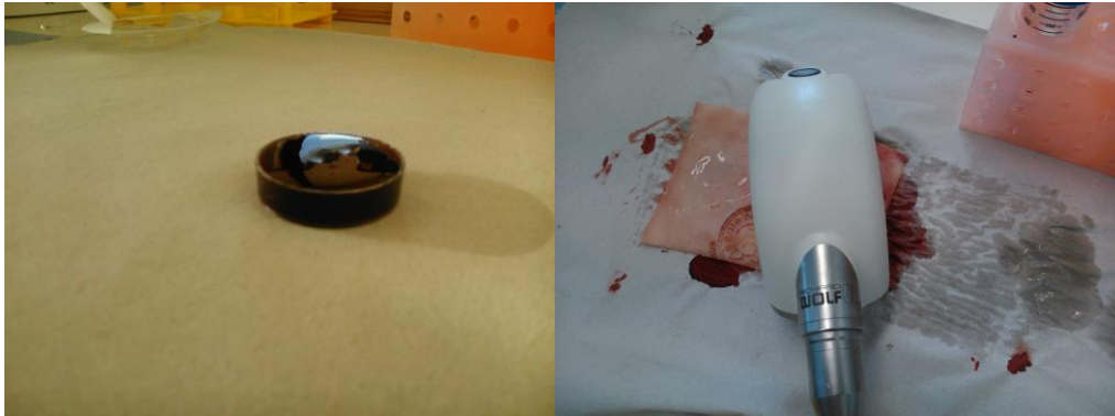
Abbildung 56: Petri-Schale mit Heparinblut (links) mit Applikation durch die Schweinehaut (rechts), eigene Darstellung
