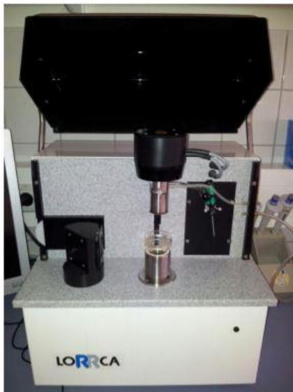
Abbildung 17: Laser-Assisted-Rotational-Cell-Analyser (LORCA) von RR Mechatronics, Niederlande (2003), eigene Darstellung
