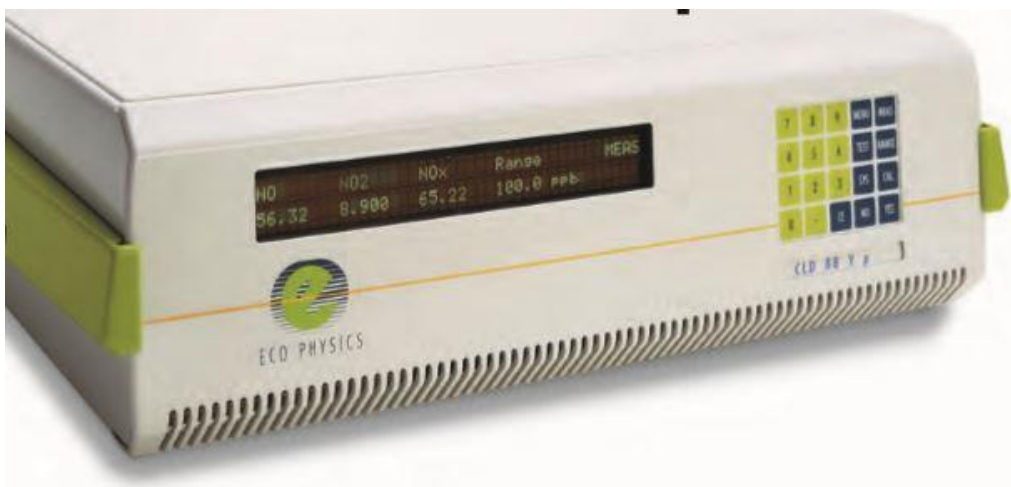
Abbildung 26: Chemiluminiszenzdetektor (CLD 88e) der Firma EcoPhysics, Schweiz (2020)
