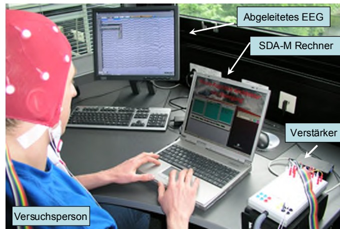
Abbildung 55 Versuchsaufbau der Methode, wie sie erstmals in einem Vorversuch verwendet wurden. In der relevanten Untersuchung hatte die Vp nur noch den Monitor zur Stimuluspräsentation und eine Reaktionsbox vor sich (vgl. Abbildung 43).
