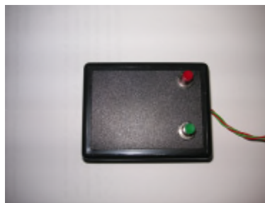
Abbildung 43 Reaktionsbox mit der die Vpn die Antwort ja oder nein oder nah oder fern geben sollten. Die Reaktionsbox war störungsfrei an der Armlehne des Untersuchungsstuhls befestigt.
