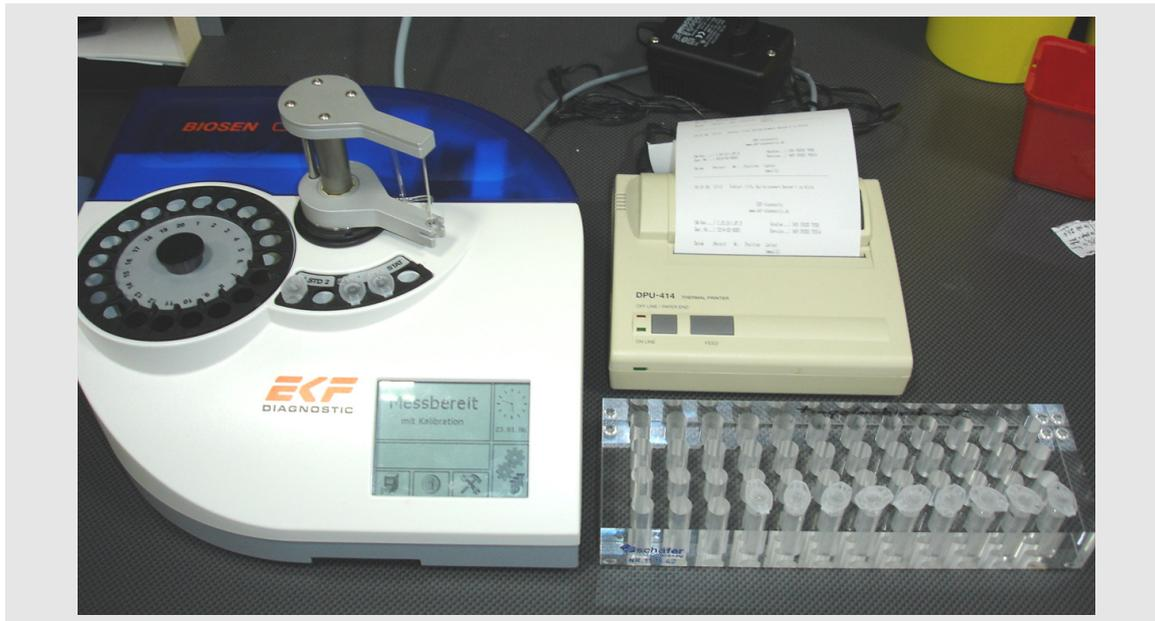
**Abb. 41:** Laktatanalysegerät „BIOSEN C\_line®“ der Firma EKF-diagnostic GmbH mit portalem Drucker und Laktatprobenhalter.
