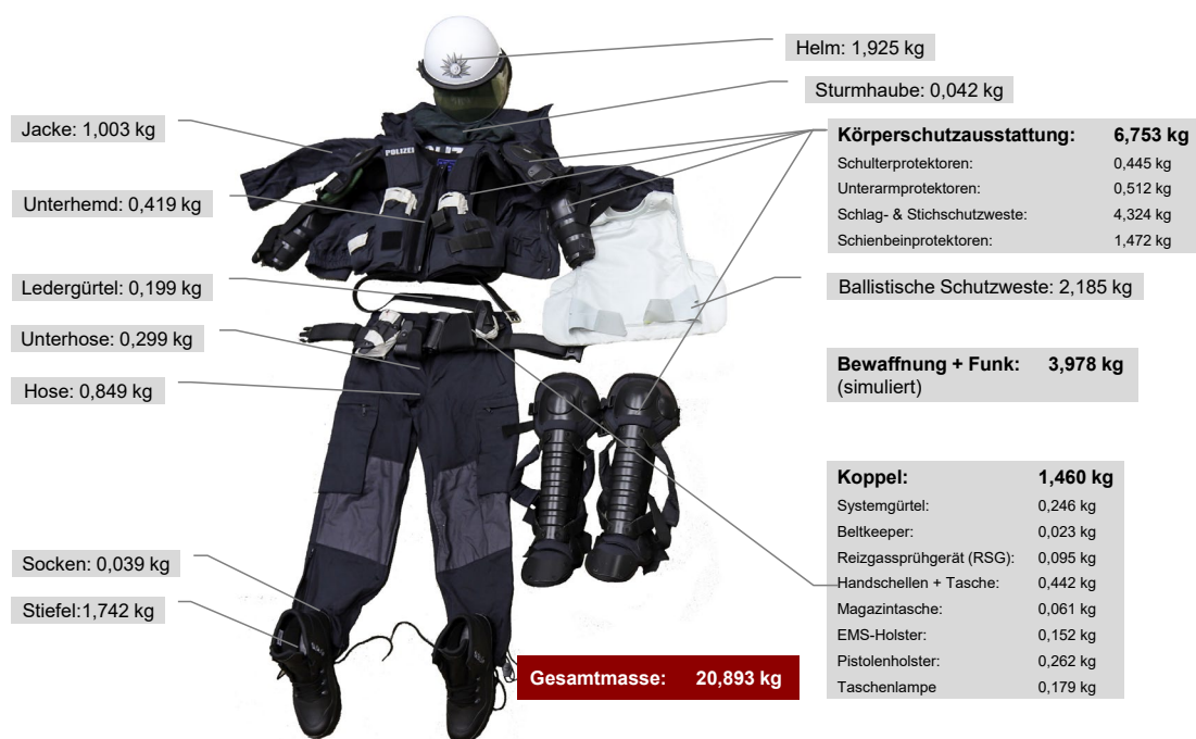
Abb. 2 Bestandteile und Masse der polizeilichen Körperschutzausrüstung in Nordrhein-Westfalen (Stand 2021). Die reale Masse der hier simulierten Bewaffnung und des Funkgerätes können abweichen.
