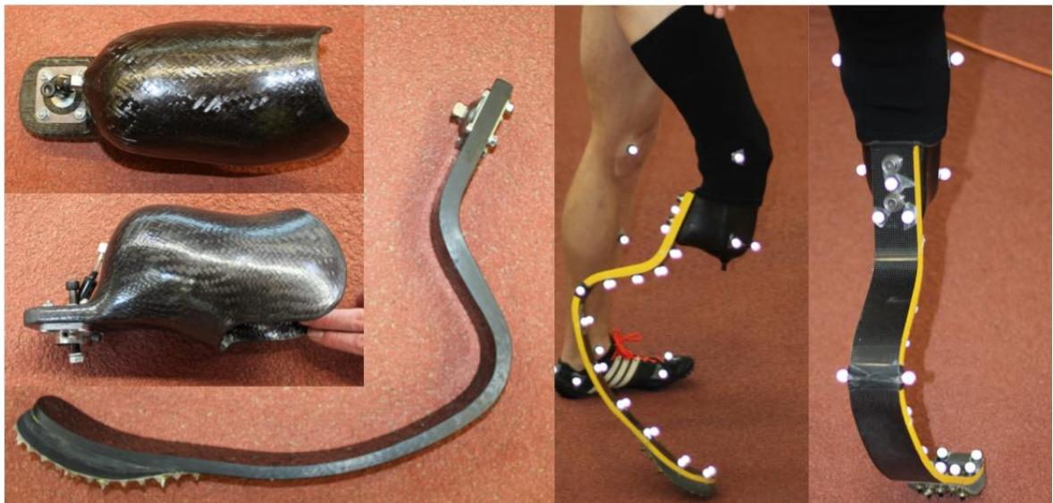
Abbildung 1: Unterschenkelprothese zum Laufen, Sprinten und Springen. Links: Schaft und Prothesenfeder als Einzelbauteile. Rechts: Gesamtprothese mit Textilüberzug und retroreflektierenden Markern für die Bewegungsanalyse
