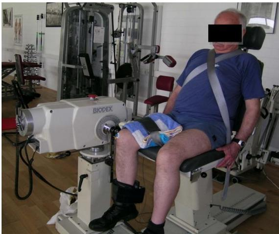
Abb. 3.24: EMG-Messung auf Biodex Medical System 2
