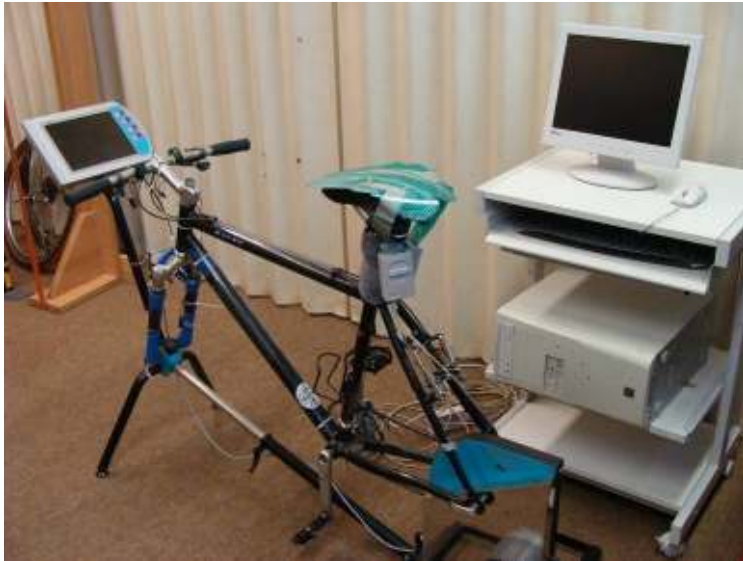
Abbildung 48: Versuchsaufbau Satteldruckmessung mit Ergometer, Fahrrad, Druckmessfolie und PC
