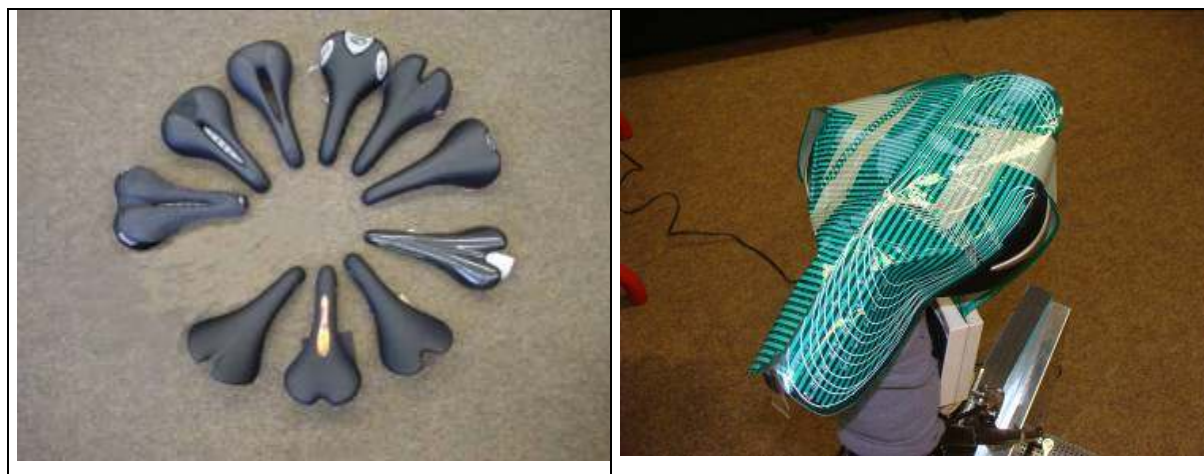
Abbildung 49: Testsättel und Aufbringung der Messfolie
