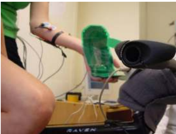
Abbildung 60: Versuchsaufbau mit aufgeklebter Druckmessfolie auf der Handinnenfläche und EMG-Sensoren am Unterarm
