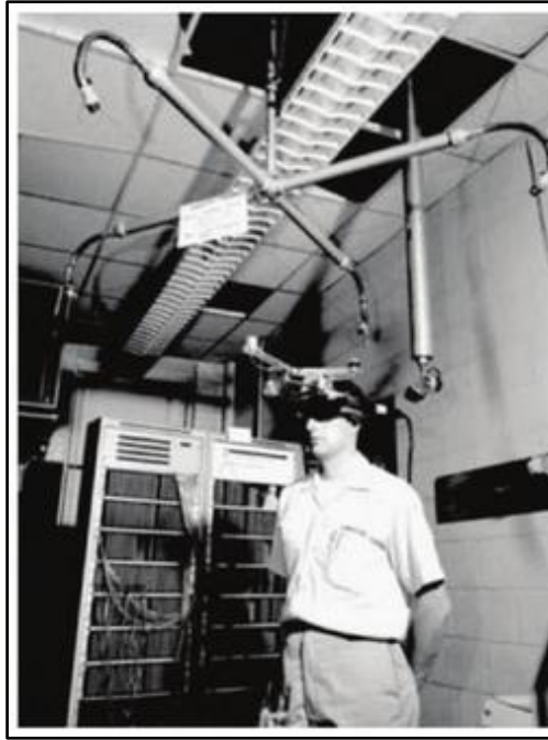
Abbildung 3: Aufhängevorrichtung und Positionserfassung zur Bestimmung der Blickrichtung (Bleser, 2017, S. 6 aus Sutherland, 1968, S. 759).
