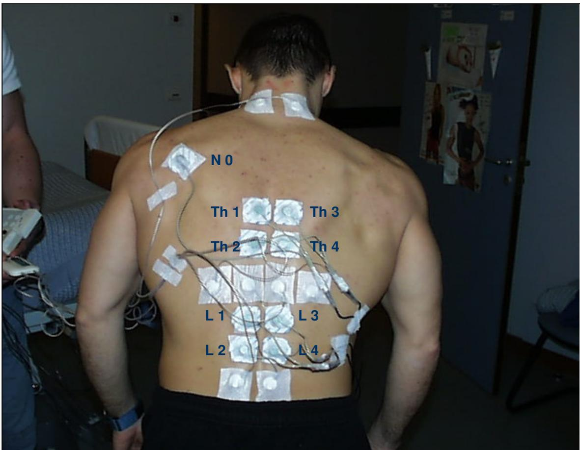
Abb. 6: Graphische Darstellung der Gesamtinstrumentierung mit Fokus auf die EMG-Diagnostik mit bipolarer Ableittechnik (N 0 = neutrale Elektrode; Th 1 und Th 2 = BWS-Bereich links; Th 3 und Th 4 = BWS-Bereich rechts; L 1 und L 2 = LWS-Bereich links; L 3 und L 4 = LWS-Bereich rechts).
